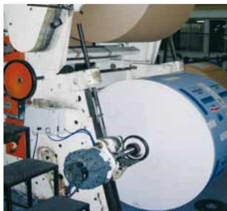
Тормоз Modulo 256 на машине, производящей бумажные пакеты (для упаковки сахара). Brake Modulo 256 on machine for paper sacks (sugar packaging).
