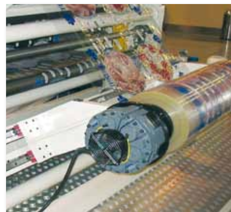
Тормоз Modulo 254 на резательной машине гибкого упаковочного материала. Brake Modulo 254 on slitting rewriter for flexible packaging.
